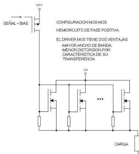
Esta configuración produce un fenómeno de sinergia en el par excitador transistor, resultando una bajísima distorsión y gran ancho de banda necesarios para una excelente performance global.
