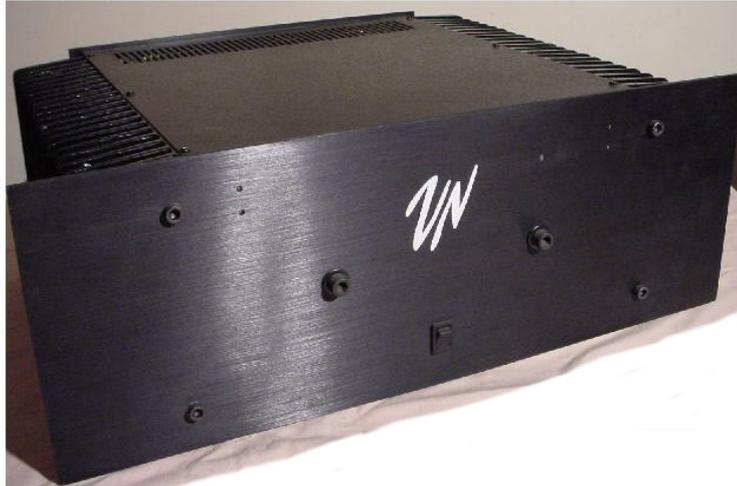
El VN 706 es un amplificador de potencia de audio construido con componentes discretos, realimentación negativa, local y global, drivers MOSFET y transistores de salida MOSFET.
