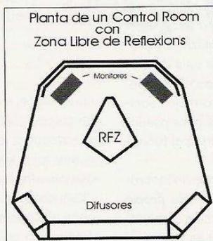
trutura, a terminação das paredes e todo o acondicionamento acústico do control room estão desenhados para a correta direção das reflexões.
